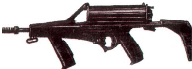
Экспериментальный ПП американской фирмы Калико с цилиндрическим магазином
