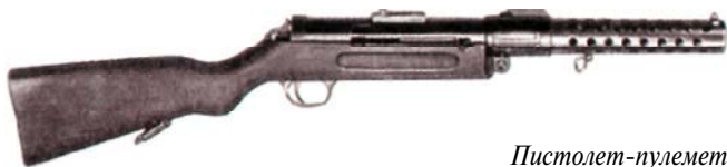
Пистолет-пулемет MP-18/1 обр. 1918 г.
