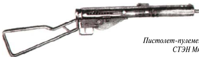
Пистолет-пулемет СТЭН Mk. 2 с приспособлением для бесшумной стрельбы
